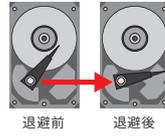
PCの不安定な動きを3D加速度センサーがキャッチし、HDDの磁気ヘッドを退避させる「東芝HDDプロテクション」を搭載。HDD損傷の危険性を軽減します。
