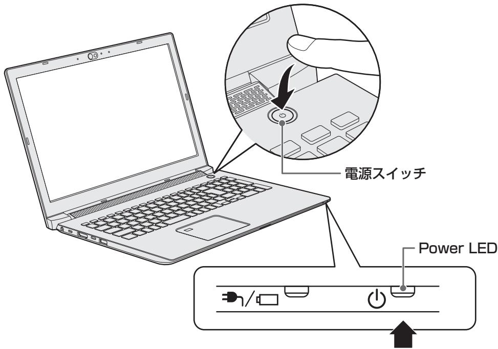
**電源の状態をシステムインジケーターで確認する**
