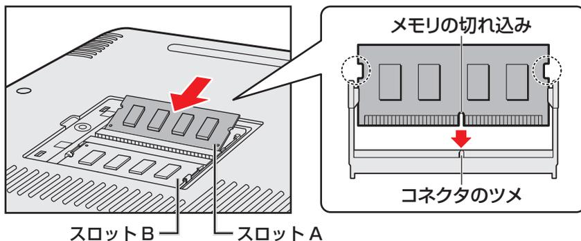
メモリの切れ込みを、メモリスロットのコネクタのツメに合わせて、しっかり差し込みます。このとき、メモリの両端（上図○で囲んだ部分）を持って差し込むようにしてください。
