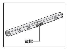
● バッテリーパックをパソコンに取り付けたときは、バッテリー安全ロックがロック側になってい ることを必ず確認してください。
