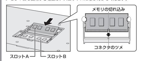
メモリの切れ込みを、メモリスロットのコネクタのツメに合わせて、しっかり差し込みます。このとき、メモリの両端(上図 () で囲んだ部分)を持って差し込むようにしてください。
