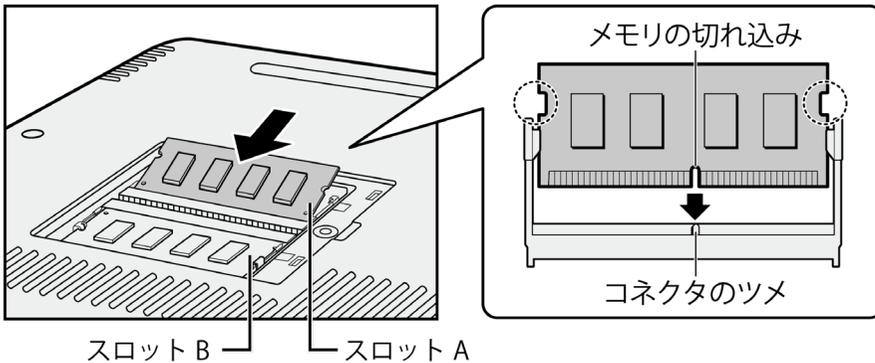
メモリの切れ込みを、メモリスロットのコネクタのツメに合わせて、しっかり差し込みます。このとき、メモリの両端（上図○で囲んだ部分）を持って差し込むようにしてください。ツメの位置が合わない場合は、メモリを裏返して差し込んでください。
