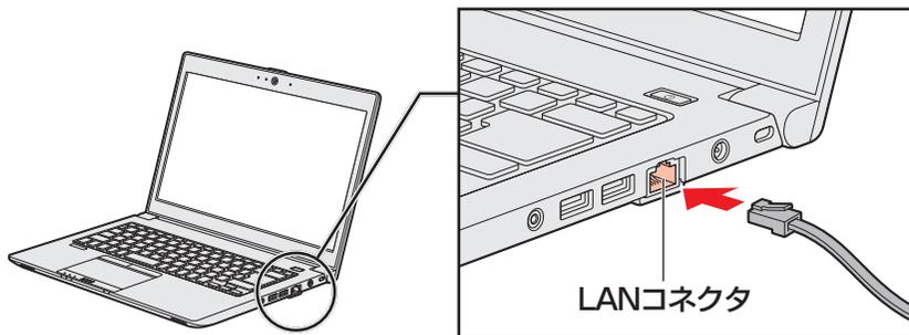
3 LANケーブルのもう一方のプラグを接続先のネットワーク機器のコネクタに差し込む
