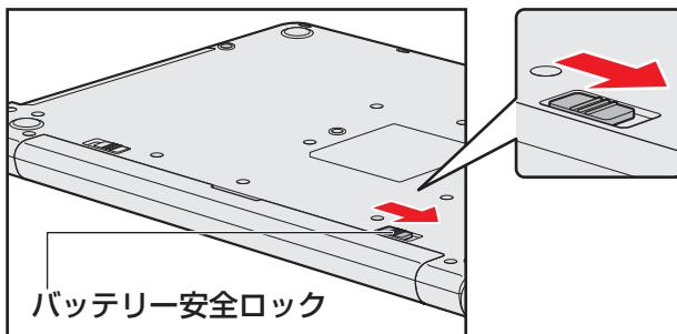
**5** バッテリー・リリースラッチをスライドしながら①、バッテリーパックを取りはずす②
