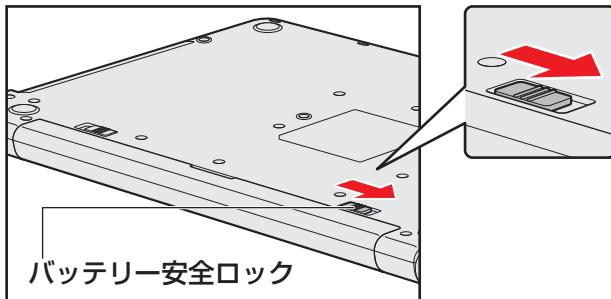
**5** バッテリー・リリースラッチをスライドしながら①、バッテリーパックを取りはずす②
