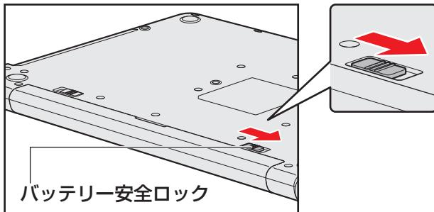
**5** バッテリー・リリースラッチをスライドしながら①、バッテリーパックを取りはずす②
