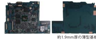
約1.9mm厚の薄型基板
