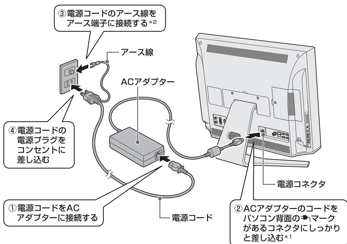
\* 1 モデルによっては、電源コネクタの形状およびACアダプターのプラグの形状が異なります。
