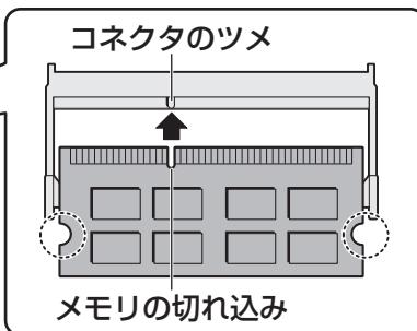
メモリの切れ込みを、メモ里斯ロットのコネクタのツメに合わせて、しっかりと差し込みます。このとき、メモリの両端（上図○で囲んだ部分）を持って差し込むようにしてください。
