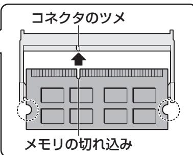
メモリの切れ込みを、メモ里斯ロットのコネクタのツメに合わせて、しっかりと差し込みます。このとき、メモリの両端（上図○で囲んだ部分）を持って差し込むようにしてください。
