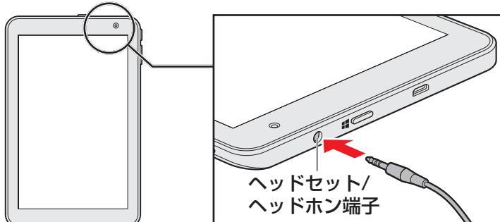
取りはずすときは、ヘッドセット/ヘッドホン端子からヘッドホンのプラグを抜きます。
