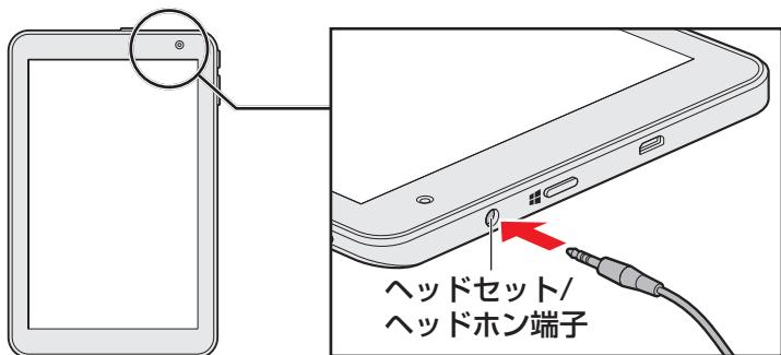
取りはずすときは、ヘッドセット/ヘッドホン端子からヘッドセットのプラグを抜きます。
