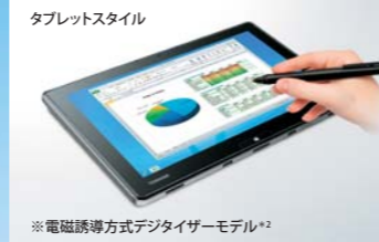
※電磁誘導方式デジタイザーモデル*2
