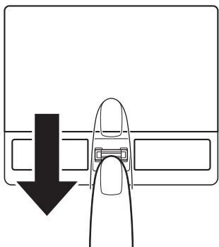
同じ指を3回認識させてください。指紋センサーに指をすべらせると、画面の3つのボックスに、1回ごとの指紋データの読み取り結果が表示されます。読み取りに成功すると、ボックスの下に「良いイメージ」と表示されます。
