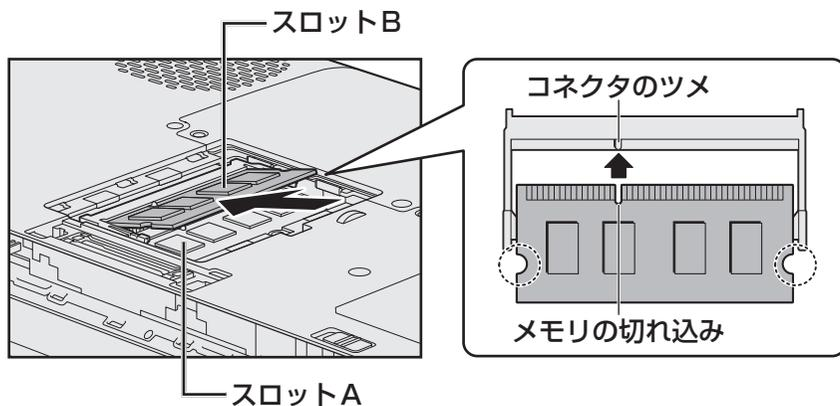
パソコンの裏面を表にした状態で、下段がスロットA、上段がスロットBです。メモリの切れ込みを、メモリスロットのコネクタのツメに合わせて、しっかり差し込みます。このとき、メモリの両端（上図○で囲んだ部分）を持って差し込むようにしてください。
