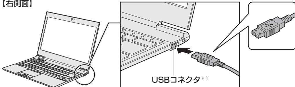
\* 1 コネクタ内部が青色のUSBコネクタは、USB3.0規格に対応しています（USB3.0コネクタ搭載モデルのみ）。
