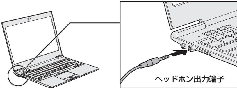
取りはずすときは、ヘッドホン出力端子からヘッドホンのプラグを抜きます。
