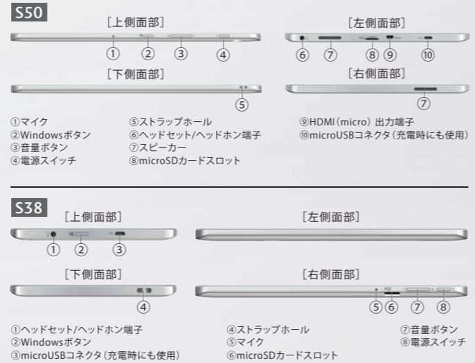
①ヘッドセット/ヘッドホン端子 ②Windowsボタン ③音量ボタン ④ストラップホール ⑤マイク ⑥ヘッドセット/ヘッドホン端子 ⑦スピーカー ⑧microSDカードスロット ⑨HDMI(micro) 出力端子 ⑩microUSBコネクタ(充電時にも使用) ⑪電源スイッチ ⑫microUSBコネクタ
