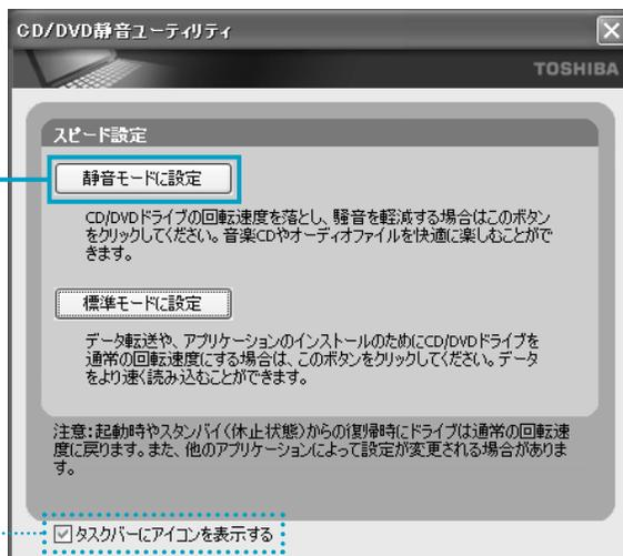
画面が閉じて、静音モードに設定されます。これでドライブの動作音が小さくなります。
