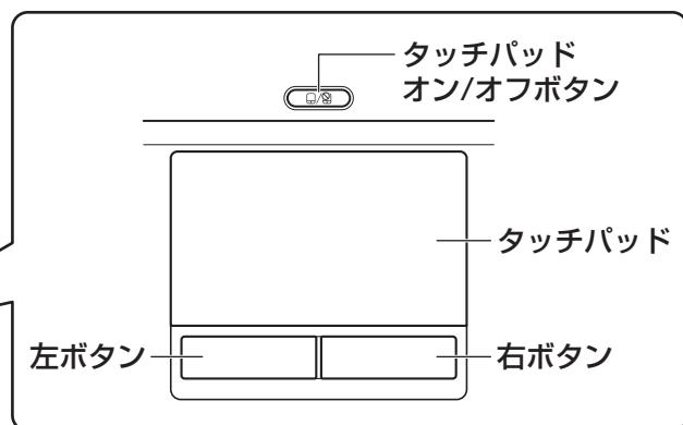
タッチパッド オン／オフボタンは、タッチパッドの有効／無効を切り替えるためのボタンです。以降、指紋センサー搭載モデルを例に説明します。
