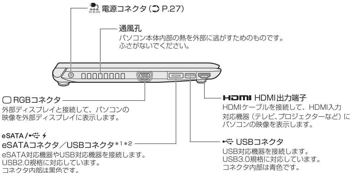
\* 1 設定を行うと、パソコン本体の電源が入っていない状態でも、USBコネクタから外部機器に電源を供給することができます。
