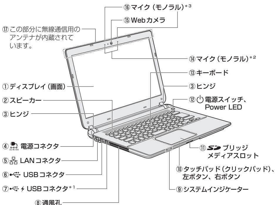
\*<sup>1</sup> USB の常時給電の設定を行うと、パソコン本体の電源が入っていない状態でも、USB コネクタから外部機器に電源を供給することができます。
