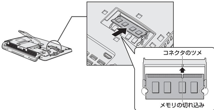
メモリの切れ込みを、メモリスロットのコネクタのツメに合わせて、しっかり差し込みます。このとき、メモリの両端（上図○で囲んだ部分）を持って差し込むようにしてください。
