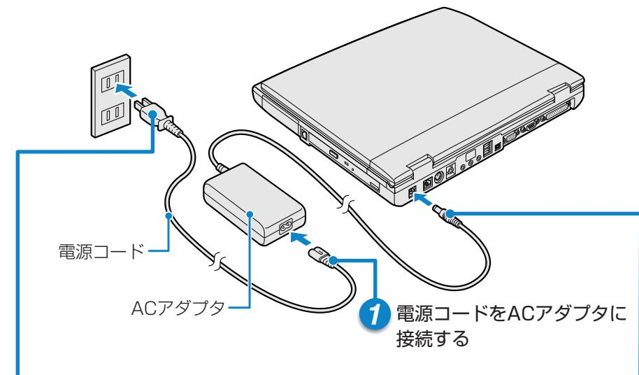
2 ACアダプタのコードをパソコン背面の電源コネクタに差し込む
