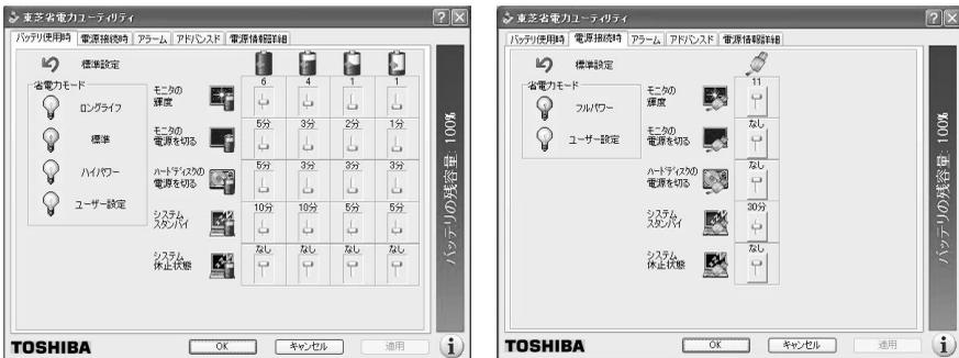
【省電力モード】で設定する省電力モードのアイコンをクリックしたあと、各項目のスライダーを動かして設定します。
