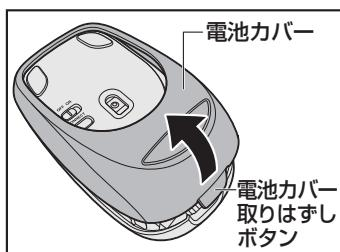
**2 乾電池をセットして、電池カバーを閉める****3 Bluetooth® マウスの裏側にある電源スイッチをON側にスライドする****⚠ 注意**
