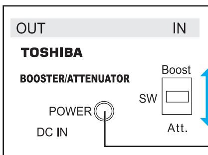
電波の弱い場合はスイッチを「Boost」側にスライドし、電波の強い場合はスイッチを「Att.」側にスライドします。
