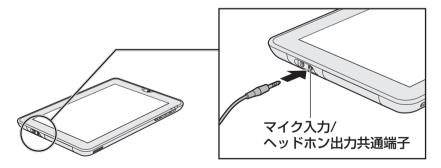
取りはずすときは、マイク入力/ヘッドホン出力共通端子からヘッドホンのプラグを抜きます。
