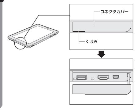
3 USBケーブルのもう一方のプラグを本製品のUSBコネクタに差し込む プラグの向きを確認して差し込んでください。
