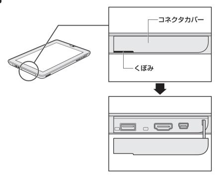
3 USBケーブルのもう一方のプラグを本製品のミニUSBコネクタに差 し込む
