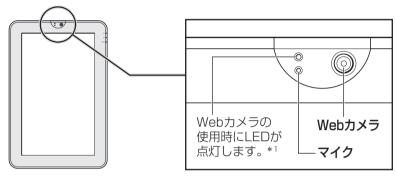
\* 1 ディスプレイ側のWebカメラを使用するときのみ点灯します。
