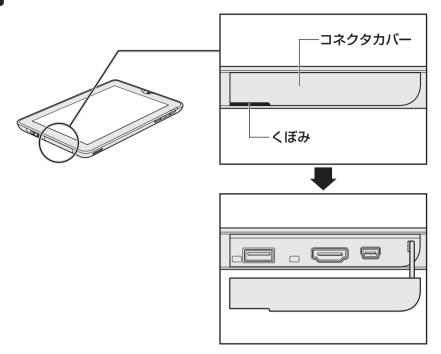
HDMIケーブルのもう一方のプラグを本製品のHDMI出力端子に差し 込む
