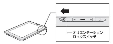
オリエンテーションロックスイッチの右側に赤い線が見えている状態のとき、画面の 向きは固定されています。
