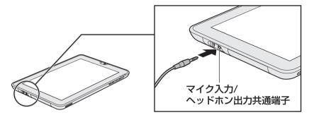
取りはずすときは、マイク入力/ヘッドホン出力共通端子からヘッドセットのプラグを抜きます。
