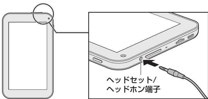
取りはずすときは、ヘッドセット/ヘッドホン端子からヘッドセットのプラグを抜きます。
