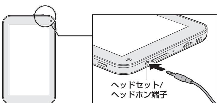
取りはずすときは、ヘッドセット/ヘッドホン端子からヘッドホンのプラグを抜きます。
