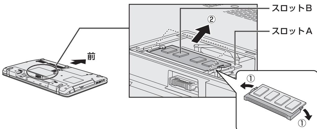
パソコンの裏面を表にした状態で、下段がスロットA、上段がスロットBです。
