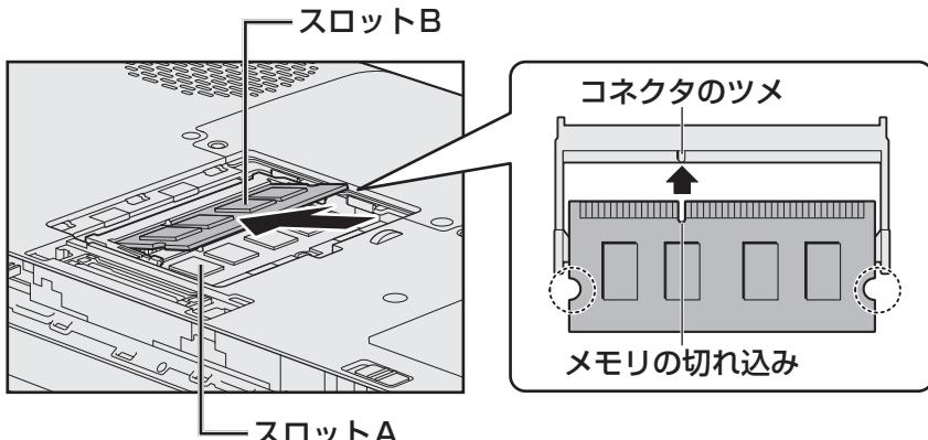
パソコンの裏面を表にした状態で、下段がスロットA、上段がスロットBです。メモリの切れ込みを、メモリスロットのコネクタのツメに合わせて、しっかりと差し込みます。このとき、メモリの両端（上図○で囲んだ部分）を持って差し込むようにしてください。
