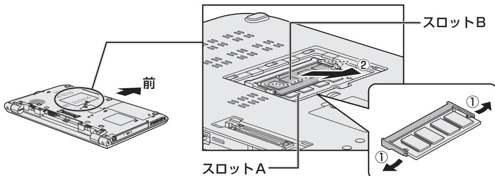
パソコンの裏面を表にした状態で、下段がスロットA、上段がスロットBです。
