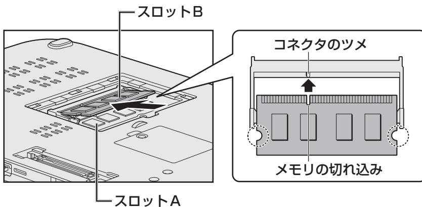
パソコンの裏面を表にした状態で、下段がスロットA、上段がスロットBです。メモリの切れ込みを、メモ里斯ロットのコネクタのツメに合わせて、しっかりと差し込みます。このとき、メモリの両端（上図○で囲んだ部分）を持って差し込むようにしてください。
