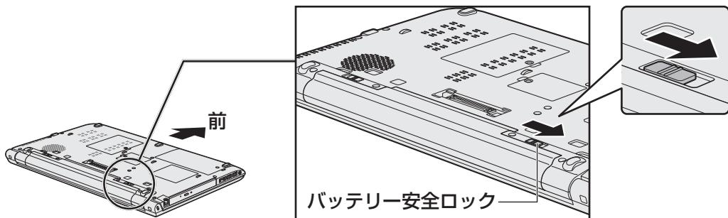
**5** バッテリー・リリースラッチをスライドしながら①、バッテリーパックを取りはずす②
