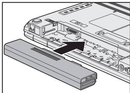
バッテリーパックがはずれないように、矢印方向にバッテリー安全ロックがスライドされているか、確認してください。
