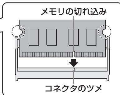
メモリの切れ込みを、メモリスロットのコネクタのツメに合わせて、しっかり差し込みます。このとき、メモリの両端（上図○で囲んだ部分）を持って差し込むようにしてください。
