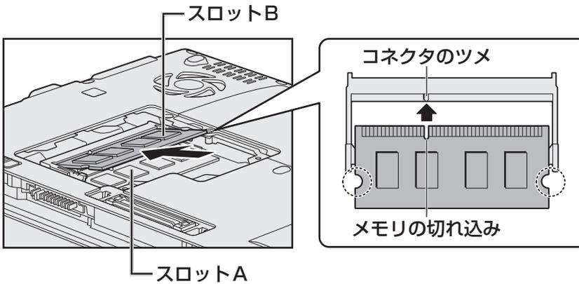
パソコンの裏面を表にした状態で、下段がスロットA、上段がスロットBです。メモリの切れ込みを、メモリスロットのコネクタのツメに合わせて、しっかり差し込みます。このとき、メモリの両端（上図○で囲んだ部分）を持って差し込むようにしてください。
