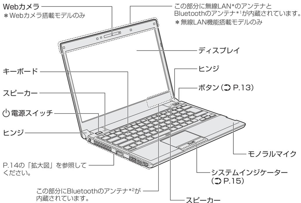
\*1・\*2 Bluetooth機能搭載モデルのみ、\*1または\*2のいずれかの位置にBluetoothのアンテナが内蔵されています。
