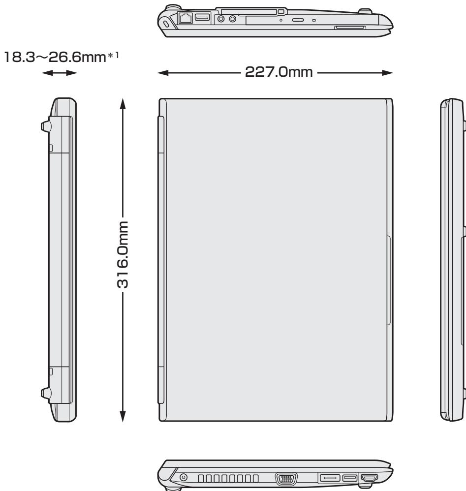
\* 1 ドライブを搭載していないモデルの最薄部は16.8mmです。
