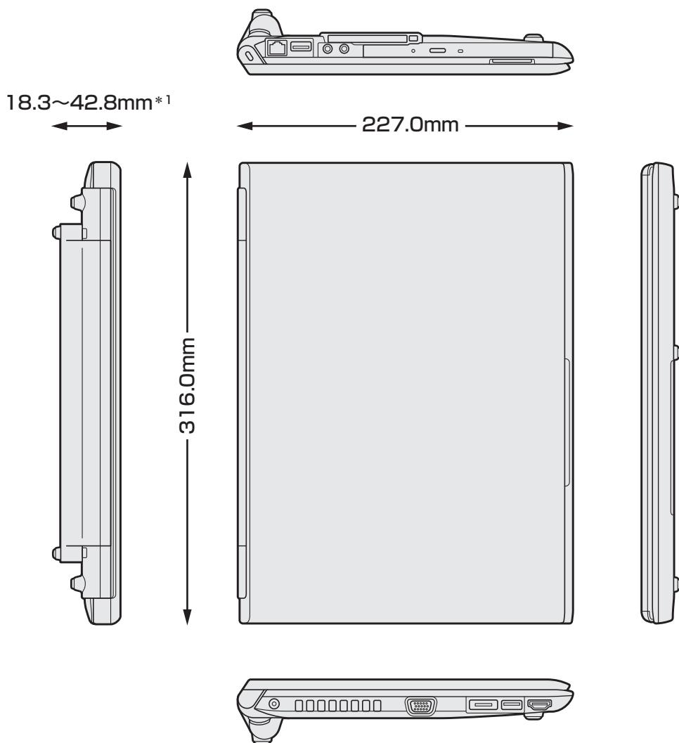
\* 1 ドライブを搭載していないモデルの最薄部は16.8mmです。
