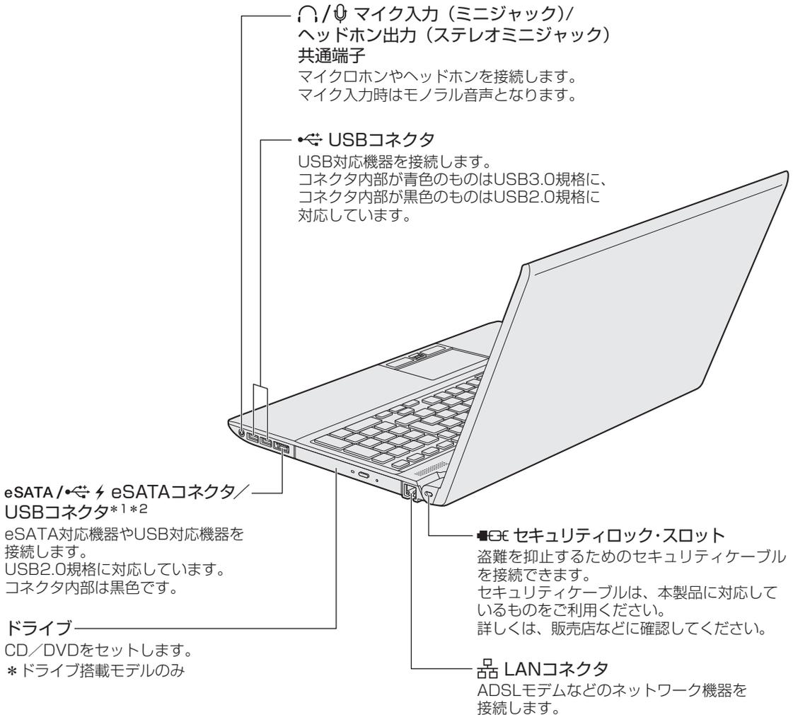
\* 1 設定を行うと、パソコン本体の電源が入っていない状態でも、USBコネクタから外部機器に電源を供給することができます。
