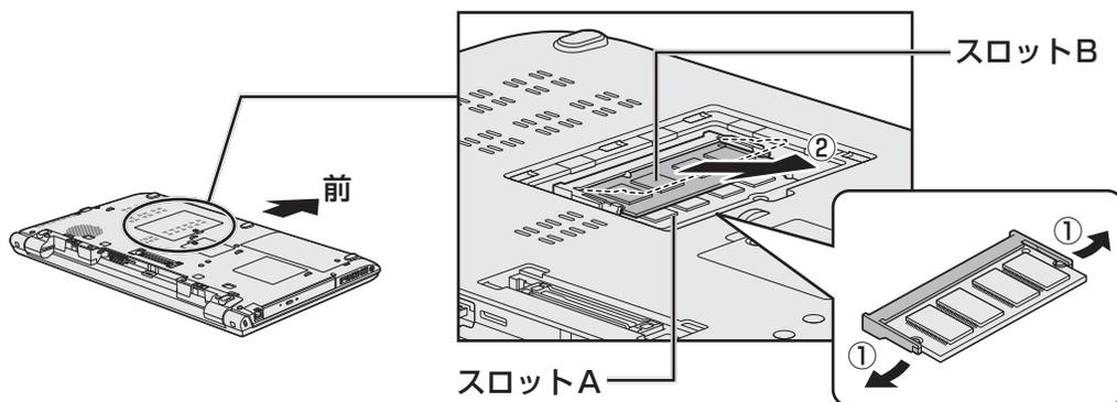
パソコンの裏面を表にした状態で、下段がスロットA、上段がスロットBです。斜めに持ち上がったメモリを引き抜きます。
