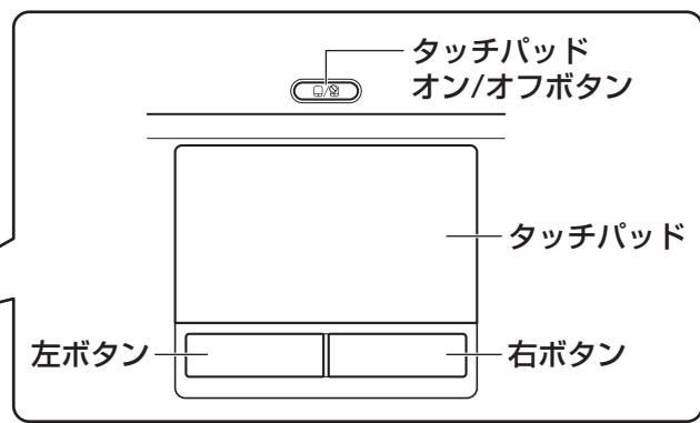
タッチパッド オン／オフボタンは、タッチパッドの有効／無効を切り替えるためのボタンです。以降、指紋センサー搭載モデルを例に説明します。
