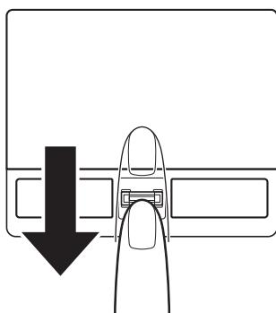
同じ指を3回認識させてください。指紋センサーに指をすべらせると、画面の3つのボックスに、1回ごとの指紋データの読み取り結果が表示されます。
