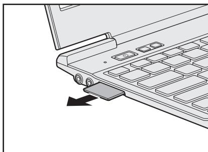
**3** SDメモリカードの表裏を確認し、表を上にして、SDカードスロットに挿入する
