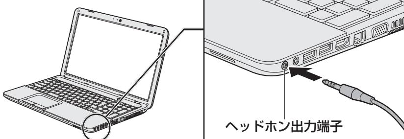
取りはずすときは、ヘッドホン出力端子からヘッドホンのプラグを抜きます。
