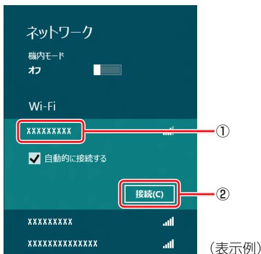
環境によっては、近隣で使用されているワイヤレスネットワークのSSIDが表示される場合もあるので、必ず目的のワイヤレスネットワークを選択してください。
