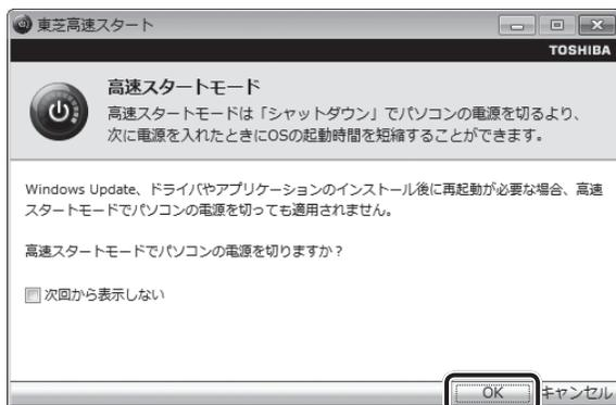
パソコン本体の電源が切れます。次に電源スイッチを押すと、高速でWindowsを起動することができます。
