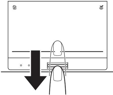
同じ指を3回認識させてください。指紋センサーに指をすべらせると、画面の3つのボックスに、1回ごとの指紋データの読み取り結果が表示されます。読み取りに成功すると、ボックスの下に「良いイメージ」と表示されます。
