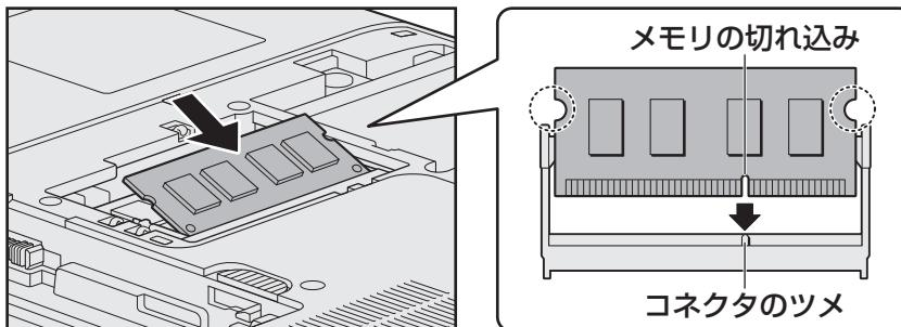
メモリの切れ込みを、メモリスロットのコネクタのツメに合わせて、しっかりと差し込みます。このとき、メモリの両端（上図○で囲んだ部分）を持って差し込むようにしてください。
