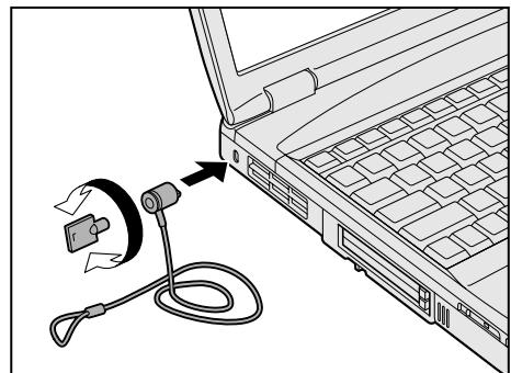
PCカードロックを有効にした後セキュリティロックをすると、PCカードの取り付け／取りはずしはできなくなります。PCカードの取り付け／取りはずしを行う場合は、セキュリティロック→PCカードの順に解除してください。
