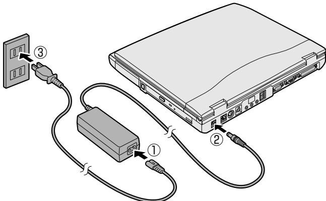
電源コードを接続したら、DC IN LEDが緑色、Battery LEDがオレンジ色に点灯するのを確認してください。
