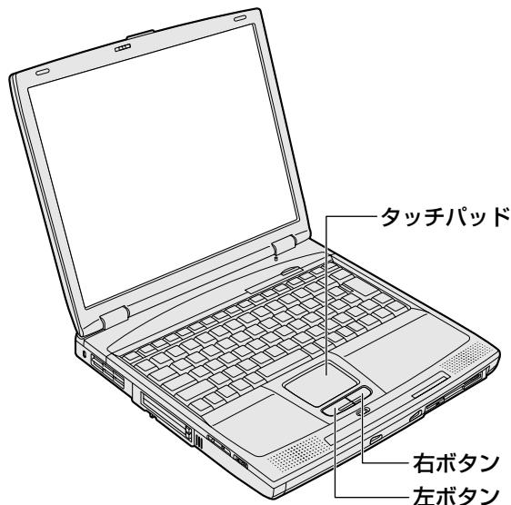
タッチパッドに指を置き、上下左右に動かすと、ポインタが指の動きにあわせて移動します。
