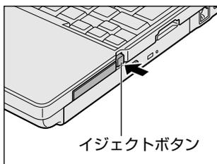
1回押すとイジェクトボタンが出てくるので、もう1度カチッと音がするまで押してください。ダミーカードが出てきます。
