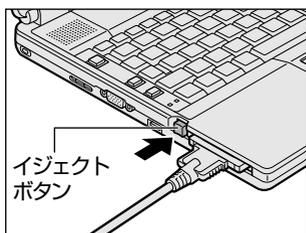
1回押すとイジェクトボタンが出てくるので、もう1度カチッと音がするまで押ししてください。カードが少し出てきます。
