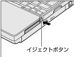
1回押すとイジェクトボタンが出てくるので、もう1度カチッと音がするまで押ししてください。コンパクトフラッシュカードが少し出てきます。
