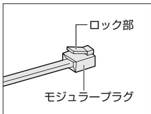
モジュラーケーブルを差し込むまたははずすときは、モジュラープラグを持って行き、ケーブルは引っ張らないでください。また、はずすときは、モジュラープラグのロック部を押さえながら抜きます。モジュラーケーブルはLANケーブルと似ているので、間違えないよう注意してください。
