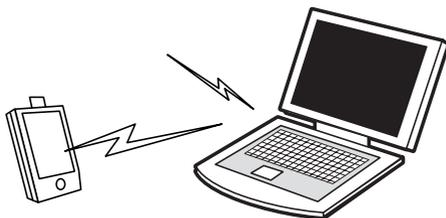
また、Bluetooth 対応機器同士でネットワークを組むこともできます。その場合、ネットワークの中心となる Bluetooth 対応機器 1 台（マスタデバイス）と、それに応答する Bluetooth 対応機器 7 台（スレーブデバイス）で最大で 8 台の構成になります。2 つ以上のネットワークに同時に参加することもできます。
