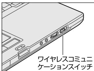
無線LANの機能を使用するかしないかを切り替えます。使用するときは右側（On）に、使用しないときは左側（Off）に切り替えてください。
