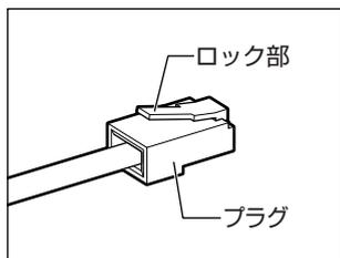
LAN ケーブルをはずしたり差し込むときは、プラグの部分を持って行ってください。また、はずすときは、プラグのロック部を押しながらずしてください。ケーブルを引っ張らないでください。
