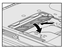
増設メモリの切れ込みを、増設メモリスロットのコネクタのツメに合わせて、しっかり差し込みます。
