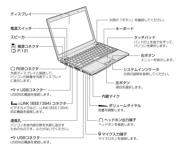
\* 1 設定を行うと、パソコン本体の電源が入っていない状態でも、USBコネクタから外部機器に電源を供給す ることができます。
