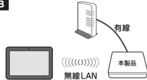
本製品を無線LANのアクセスポイントとして使用し、タブレットと無線LANで接続します。無線LANのネットワーク環境はあるが、ルーターに有線LANコネクタがない場合や、家庭のアンテナ端子とルーターの位置が遠すぎて、有線LANで接続できないなど、本製品を無線LANでネットワークに接続したい場合は、こちらを選択してください。
