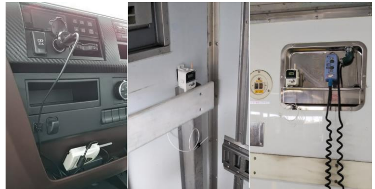
左：シガーソケットから給電のGPSモジュール端末(灰)とセンサー親機(白) 中：冷蔵車の空調機付近に設置したセンサー子機 右：冷蔵車のリア扉付近に設置したセンサー子機
