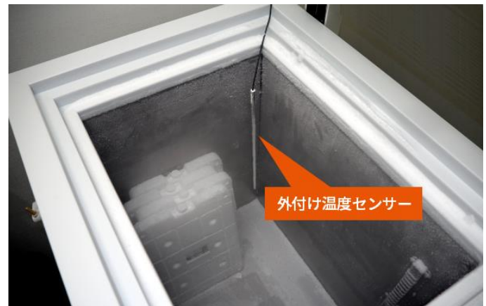
超低温フリーザー内に引き込んでいる外付け温度センサー
