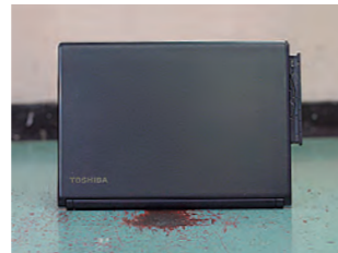
■落下試験(筐体) さまざまな角度から製品を落下させて、各部位の耐久性を調べます。
