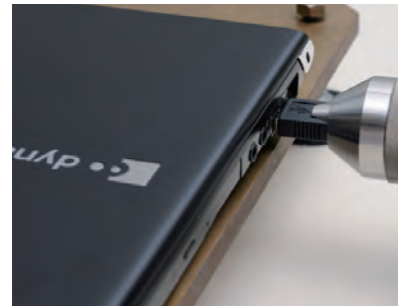
■コネクタこじり試験 コネクタ部分に「こじり」(回転)によるストレスを加え、接続部の耐久性を確認します。
