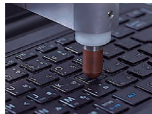
■キーボードランボリン試験 押したキーの周囲がどれくらいたわむかを検証。ミリ単位で測定します。
