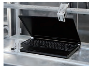
■ヒンジ開閉試験 ディスプレイの開閉を連続的に実施し、PCのヒンジへの影響を確認します。
